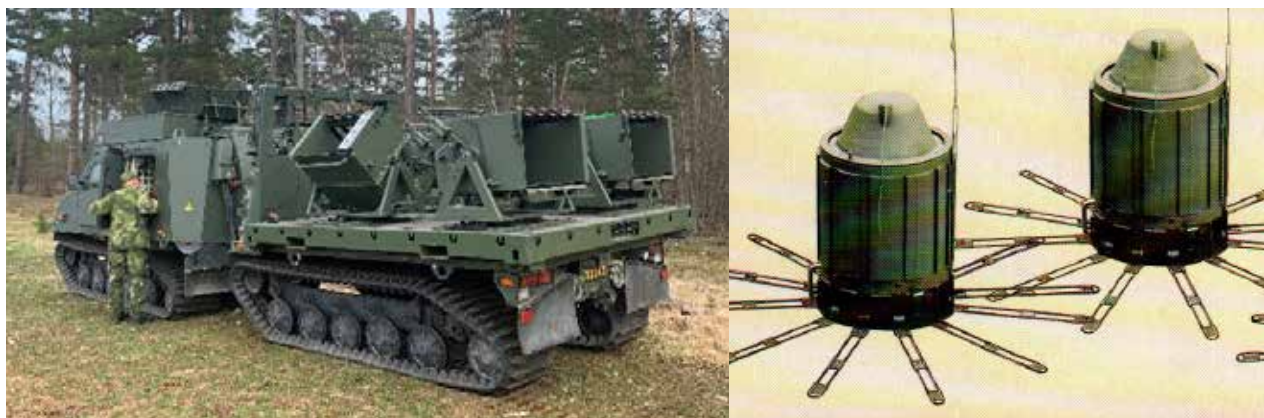
Bandvagn 410 med monterad minkastare under skjutprov på Ränneslätt. Till höger: AT2 Minor Foto: Försöksavdelningen
