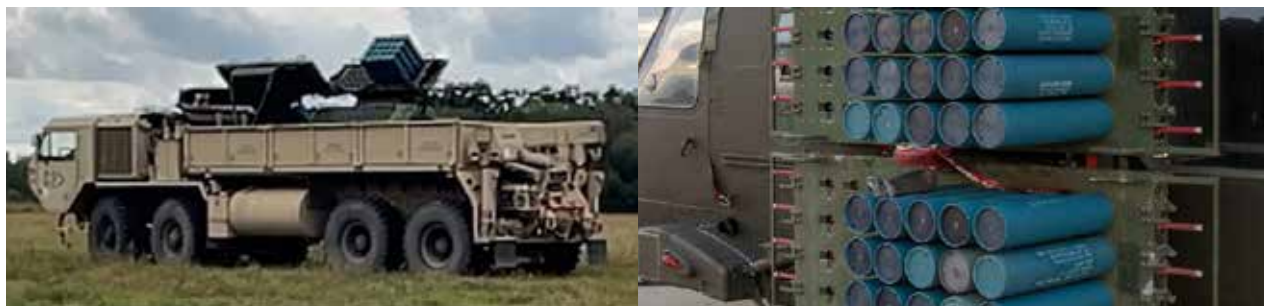
Till vänster: M126 Volcano på amerikansk lastbil. Till höger: Volcano kan monteras på Blackhawkhelikopter. Foto: Försöksavdelningen
