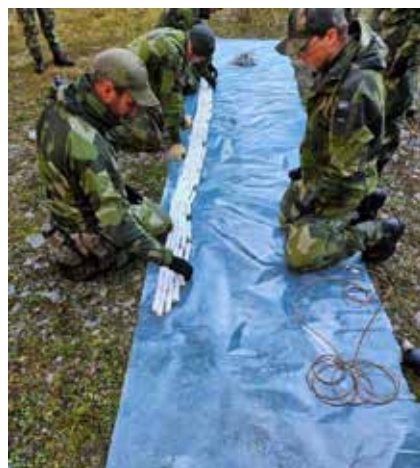
Kadetterna på Fältarbetsskolan är mycket nöjda med utbildningen och de höga smällar som den erbjuder. Bilden visar hur kadetterna tillverkar en provisorisk slangladdning som nyttjas till att spränga vägtrummor.
