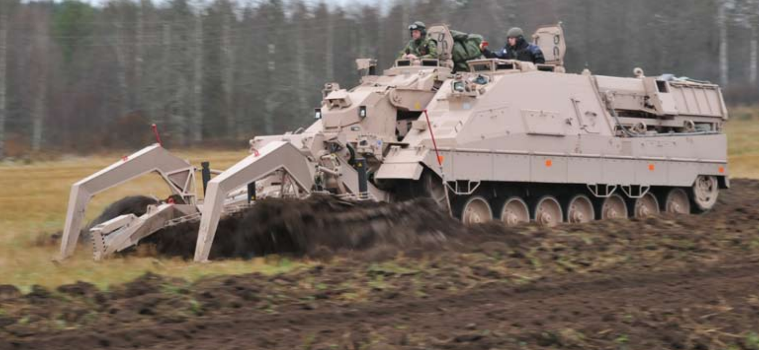
På en åker i Hamnaryd genomfördes utbildning på minbrytningssystemet på ingenjörbandvagnen.
