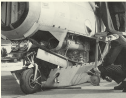
Under buken satt en SKa 10/150 med 1 500 mm objektiv för fotografering på mycket långa avstånd.
