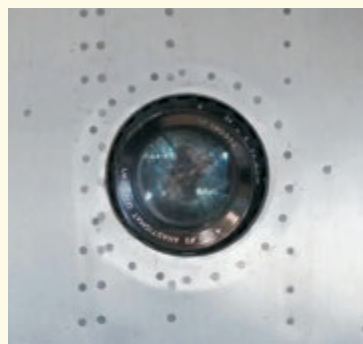
Bakom den runda glasrutan satt ląghöjdskameran SKa 16 som tog skarpa bilder med mycket korta exponeringstider.
