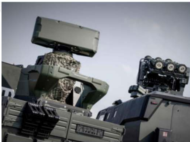
Radarenheten som är monterad på fordonet till vänster baseras på Saabs Giraffe 1X. På det högra fordonet syns eldenhet 98.
