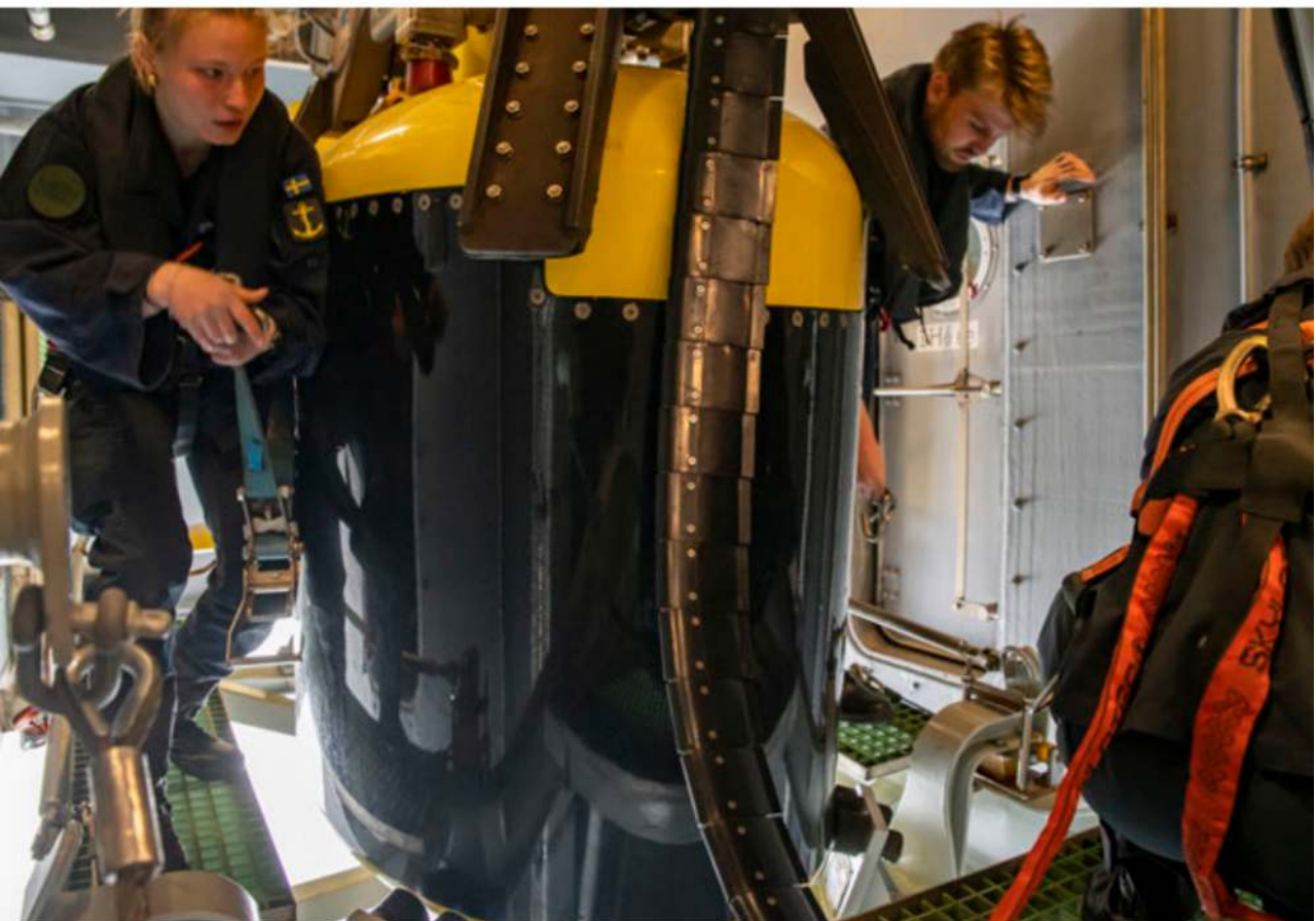
Den variabla djupsonaren kan sänkas ned och släpas efter fartyget på olika djup. Genom att placera sensorn i vattenvolymens olika salt- och temperaturskikt kan besättningen hitta en ubåt som gömmer sig.
