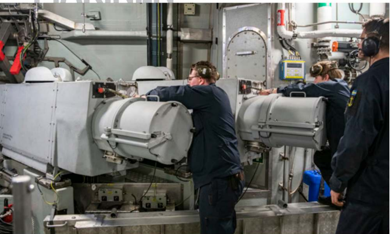
Fartygets vapentekniker klagör torpederna för skott.
