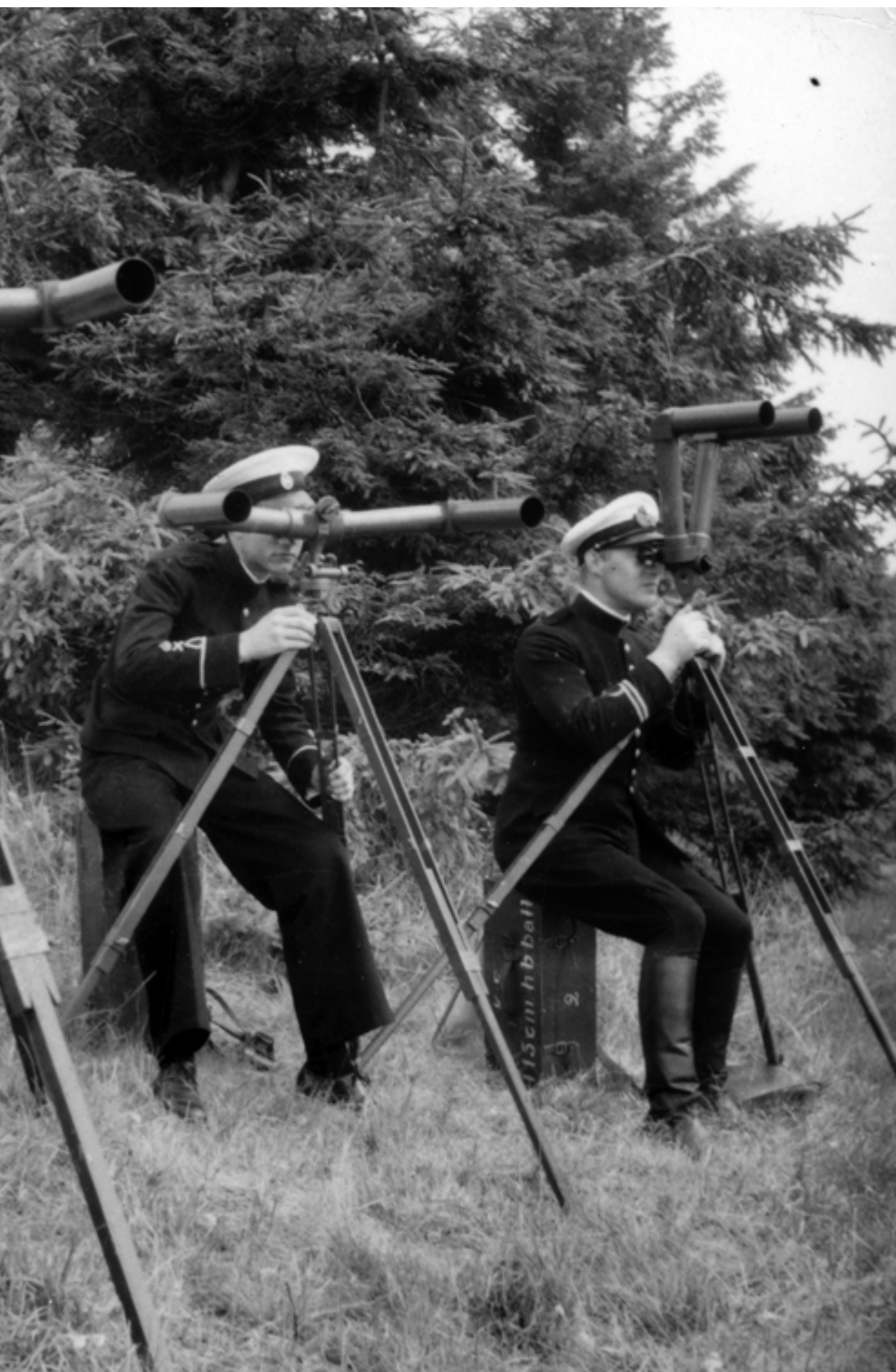
Batterikikare användes för avståndsbedömning vid eldledning. Den höga graden av förstoring gjorde ofta montering på stativ nödvändig. I dag används laserteknik.
