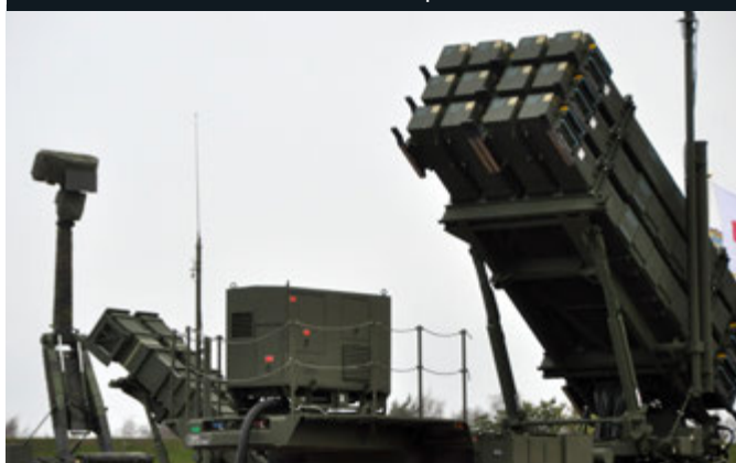
En eldenhet består av tre lavetter för två typer av robotar, ledningsplats, spanings- och eldledningsradar, elverk, reparationsenhet och dragfordon.
