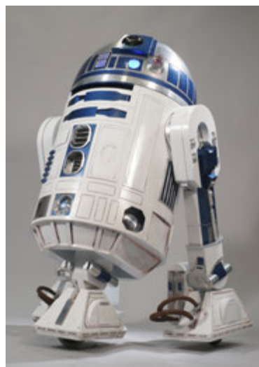
Roboten styrs av 15 servomotorer som är placerade i huvudet, domen.
