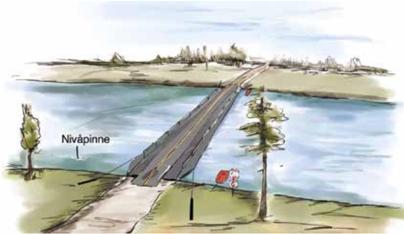
Bild 5.3. Utbyggd förbindelse med säkerhetsutrustning (exempel)
