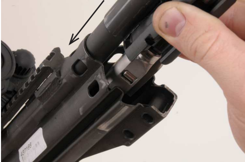
Bild 68 Mekanism isättning i lådan.
