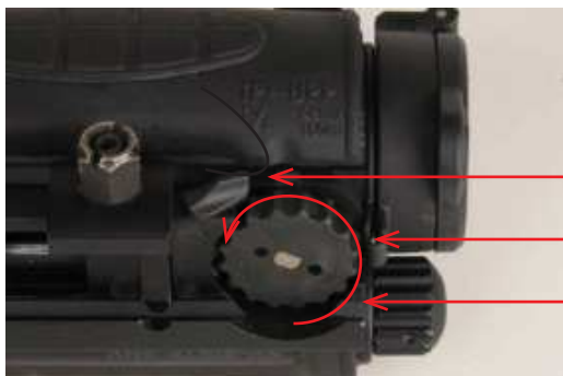
Bild 74 Höjdjustering. Rödpunktsikte snett underifrån.
