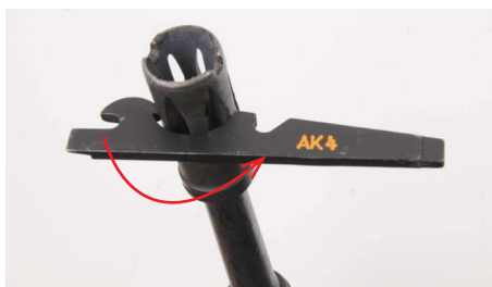
Bild 43 Demontering av flamdämpare.
