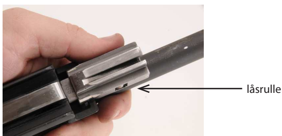
Bild 67 Hopsättning grepp låsrullar.
