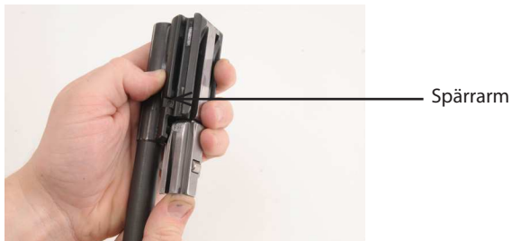
Bild 64 Hopsättning slutstyckshuvud (alternativ) .
