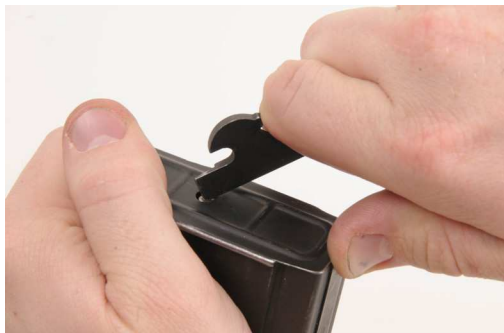
Bild 46 Isärtagning av magasin.
