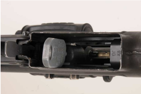
Bild 112 Patronlägeslås urtagning mom 4.
