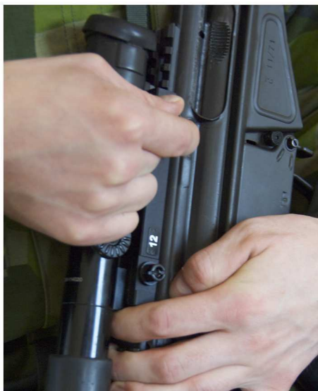
Bild 81 Kikarsikte 09 fastsättning på vapen.
