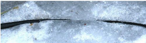
Bild 16.1 Fastfrusen kabel. Bild: Erik Falck/ Försvarmakten/Ur Vintersoldat 2016
