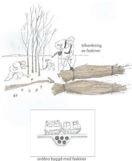
Bild 10.17 Tillverkning och nyttjande av snöbro med faskiner. Illustration: William Haddock/Ur Vintersoldat 2016
