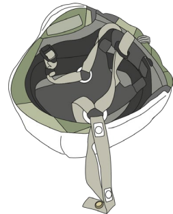
Bild 4.9 Tejpa metallringarna och insidan av tryckknapparna på hjälm 90. Illustration: FMVE
