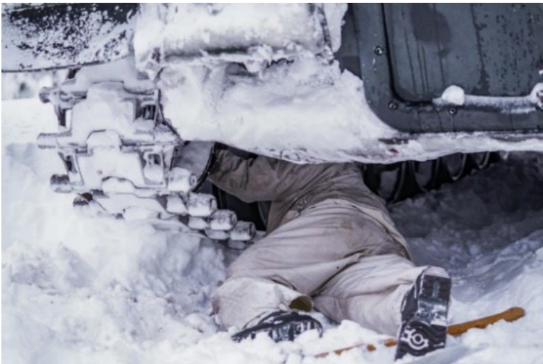
Bild 15.5 Packa snön innan du ställer ditt fordon, och rensa bandaggregatet från is och snö. Även hjulfordon rensas från is och snö.
