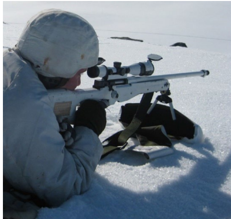
Bild 7.10 Prickskytt som använder kikarsiktets dammskydd som underlag för benstöden. Bild: Jens Eliasson/Försvarmakten/Ur Vintersoldat 2016
