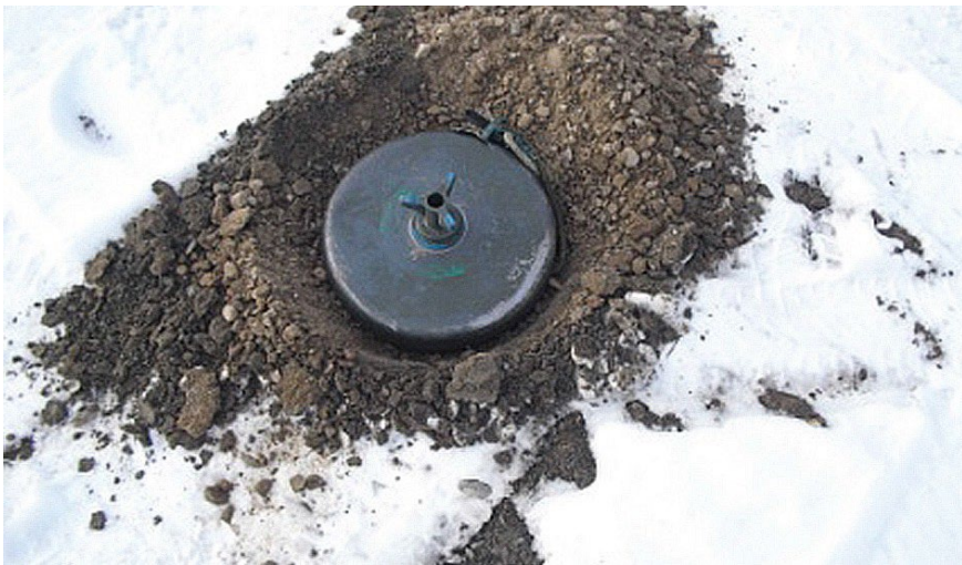
Bild 10.19 Stridsvagnsmina i mingrop upptagen med minborr. Bild: Erik Hansson/ Försvarsmakten/Ur Vintersoldat 2016
