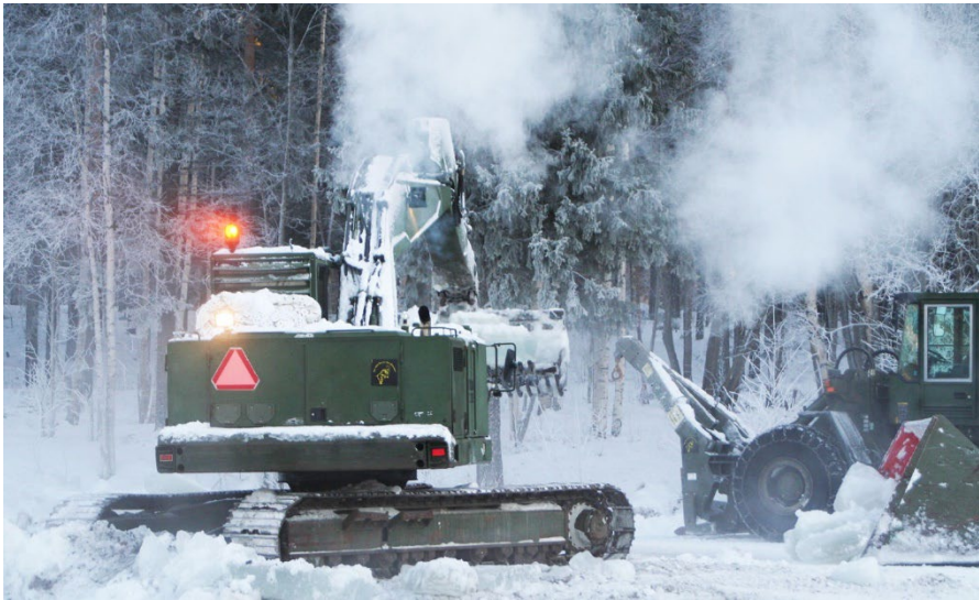
Bild 13.8 Varmkör stora hydraulsystem innan du använder dem i kyla.
