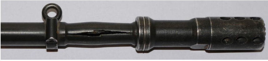
Bild 7.4 Pipsprängning. Bild: Per Arvidsson, FMV/Ur Vintersoldat 2016
