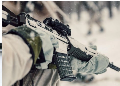
Bild 7.2 Snö och kondens riskerar att frysa till is och störa funktionen på vapnet. Bild: David Kristiansen/ Försvarsmakten
