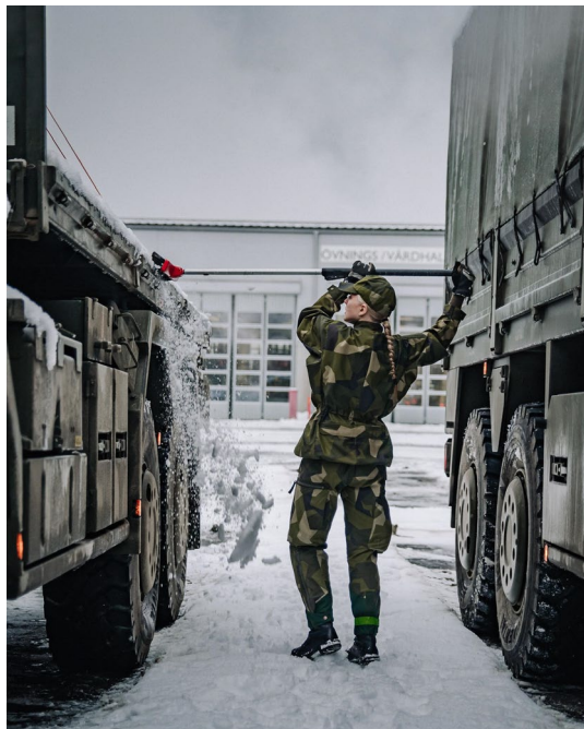
Bild 13.6 Ta bort snö och is från rörliga delar och platser där isen hindrar funktion eller utgör en halkrisk. Bild: David Luttu Carr/Försvarsmakten
