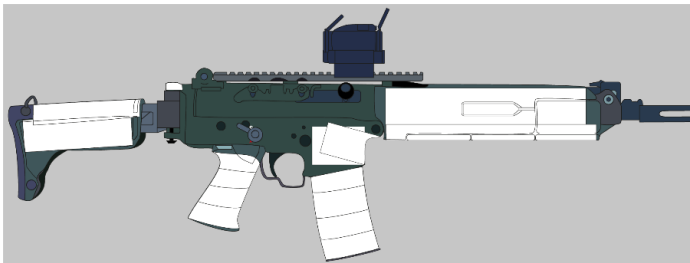
Bild 7.5 Exempel på Ak5C tejpad för att förebygga kylskador. Illustration: FMVE
