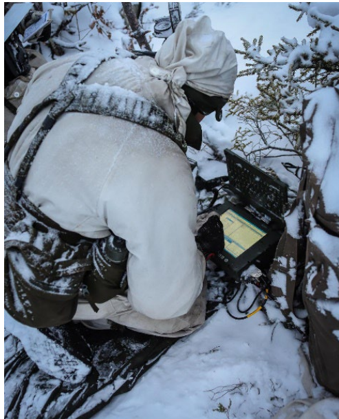
Bild 16.3 Förvara datorer och bildskärmar uppvärmt så länge som möjligt, så att de fungerar när du behöver dem.
