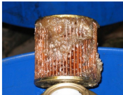
Bild 13.5 Igensatt bränslefilter, Afghanistan 2008. Bild: Roland Truedsson/ Försvarmakten/Ur vintersoldat 2016
