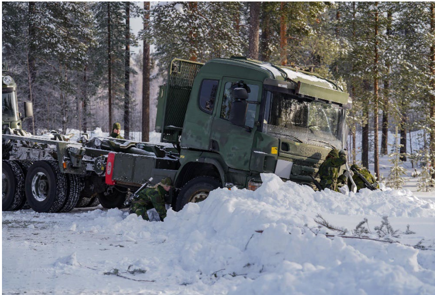
Bild 11.9 Gräv för att underlätta inför bogsering av fastkört fordon. Bild: Erik Rehnberg/Försvarsmakten
