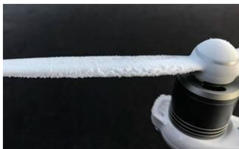
Bild 12.5 Exempel på isbildning på rotorblad. Även mycket tunna islager kan påverka flygförmågan.
