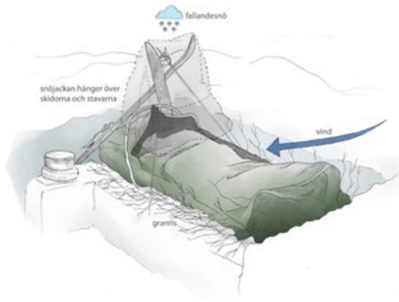
Bild 15.24 Enmansförläggning med köldgrop och snödräktsjacka som skydd mot fallande snö vid huvudet. Illustration: William Haddock/Ur Vintersoldat 2016
