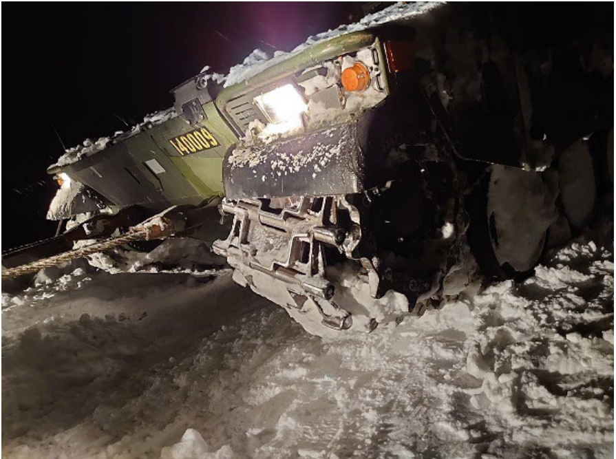
Bild 11.10 Stridsfordon där snö packats i bandaggregatet och krängt av bandet från drivhjul. Bild: Peter Kaneklint/Försvarsmakten
