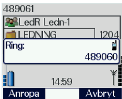
Bild 5.3. Inmatning av ISSI-nummer, bild ett med hela ISSI och bild två med förkortad nummerslagning. Den stående radion indikerar att växeln kan koppla samtalet utan särskild analys.
