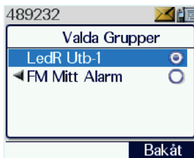
Bild 3.38. Valda grupper. De talgrupper som för tillfället kan nå radion visas.
