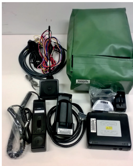
Bild 3.2. Monteringssats fordon för Ra 1444/1445. Gunnar Allard/Försvarsmakten
