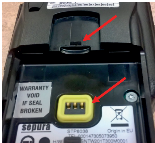
Bild 3.16. Hållare för bältesclips och batterikontakt. Dessa kan skadas vid oförsiktig hantering.
