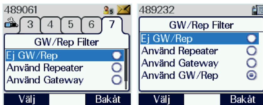
Bild 3.47. Gateway/repeater filter på Ra 1444 respektive Ra 1445/5444.
