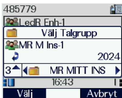
Bild 4.3. Arbetsruta vid sökning/val av talgrupper. Användaren har just öppnat mappen FM NAT/REG – MITT – MR MITT INS. Pilarna anger möjliga navigationsriktningar och siffran i nedre vänstra hörnet anger mappnivån.
