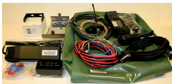
Bild 3.8. Monteringssats fordon för Ra 5444. Gunnar Allard/Försvarsmakten
