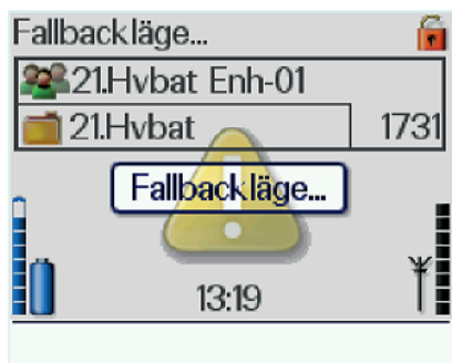
Bild 3.24. Basstationen är i fallbackläge. Radion larmar med ljud och text.
