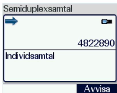
Bild 5.9. Inkommande individanrop i semiduplex.
