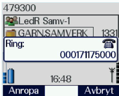
Bild 5.17. 1. Anrop till externt nummer. Telefonsymbolen leder till nummeranalys för allmänna telefontätet. De två inledande nollorna är för att komma ut på nätet eftersom vi är kopplade via Försvarmaktens växel. Jämför med externt samtal från "skrivbordstelefon". 2. Inkommande samtal från allmänna telefontätet. Uppringande nummer presenteras utan nolla i riktnumret.
