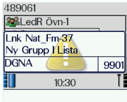
Bild 4.10. En talgrupp har tilldelats radion. Talgruppen lägger sig i mappen "DGNA" och användaren varskos med en ton och ett flashmeddelande.
