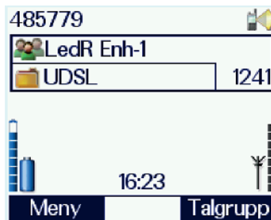
Bild 4.23. Teckenfönstret då UDSL-listan är vald och scanningen är aktiv. Teckenfönstret visar den talgrupp som är markerad som vald (📍) vid definiering av listan.
