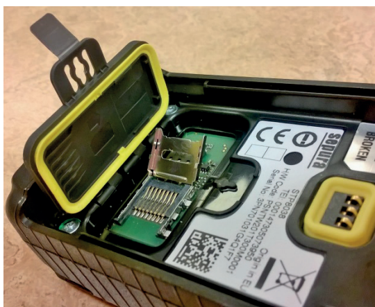
Bild 3.13. Hållare för krypto- och SD-kort. Gunnar Allard/Försvarmakten
