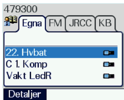
Bild 5.18. I den egna delen av telefonboken kan användaren lägga in de funktioner och nummer som ofta rings upp.
