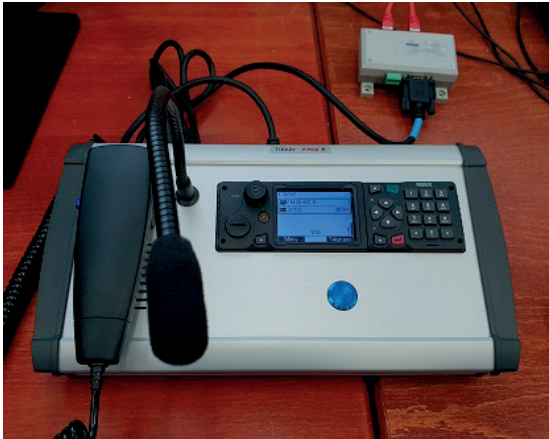
Bild 3.9. Monteringssats T 15 för Ra 5444. Manöverkonsol. Även en modell som liknar konsolen till T 30 levereras. Se bild 3.11. Gunnar Allard/Försvarsmakten
