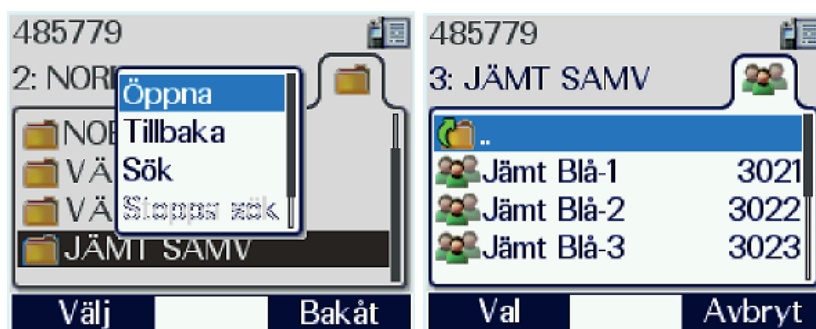
Bild 4.7. Val av talgrupp via meny. 2:an och mappnamnet uppe till vänster visar att vi befinner oss på mappnivå 2. Vid valet "Öppna" går vi in i mappnivå 3 och talgrupperna kan väljas.
