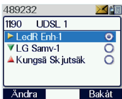
Bild 4.20. Steg 9 – UDSL-lista 1 är sparad. 1190 är listans indexnummer. Prioritetspilarna i bilden är valda för att visa alla möjligheter. I normala fall fungerar endast prioritetsval för några få talgruppsskategorier, varav Skjutsäk är en.
