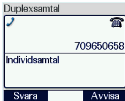
Bild 5.17. 1. Anrop till externt nummer. Telefonsymbolen leder till nummeranalys för allmänna telefontätet. De två inledande nollorna är för att komma ut på nätet eftersom vi är kopplade via Försvarmaktens växel. Jämför med externt samtal från "skrivbordstelefon". 2. Inkommande samtal från allmänna telefontätet. Uppringande nummer presenteras utan nolla i riktnumret.
