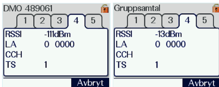
Bild 4. Denna meny kan även användas i DMO. RSSI-värdet ska ligga runt -106dBm då ingen sänder. Om det ligger markant högre tyder det på att en lokal störning förekommer på frekvensen. Testa i så fall den andra DMO-talgruppen för att se om det är bättre där. Då motstationen sänder kan du kontrollera mottagen signalstyrka. Samma kriterier för signalstyrka som i bild 3 gäller.
