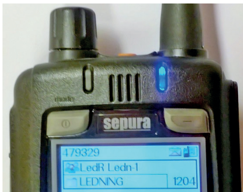
Bild 5.13. Ett obesvarat individanrop indikeras med att lysdioden för "missade händelser" börjar blinka.
