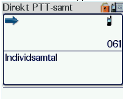
Bild 5.11. Inkommande direktsamtal i DMO. Endast skillnaden mellan det uppringande och det uppringda numret presenteras.
