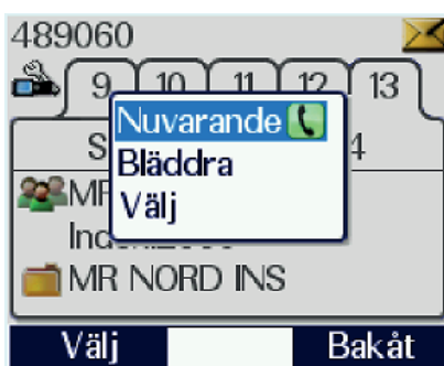
Bild 4.28. Valruta för inläggning av talgrupper finns direkt på menykortet där valen påverkar den markerade raden eller i detaljvyn där bättre kontroll över åtgärderna erbjuds. Lursymbolen anger att du kan snabbvälja denna funktion med grön lur. Valet "Detaljer" leder till detaljvyn. Valet "Nuvarande" används för lagring enligt avsnitt 4.5.2. och "Bläddra" används för lagring enligt avsnitt 4.5.1. och valet "Välj" väljer talgruppen direkt från menyn.
