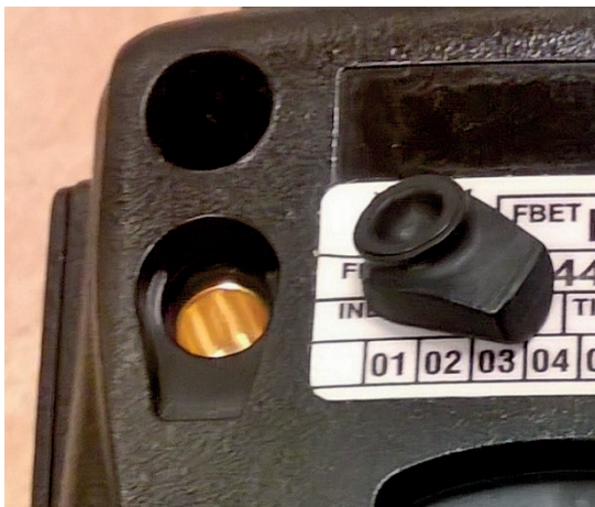
Bild 3.15. Anslutning för fordonshållarens antenn.
