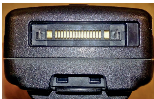
Bild 3.14. Kontakt för anslutning av laddare, datorer och annan extern utrustning. Gunnar Allard/Försvarmakten
