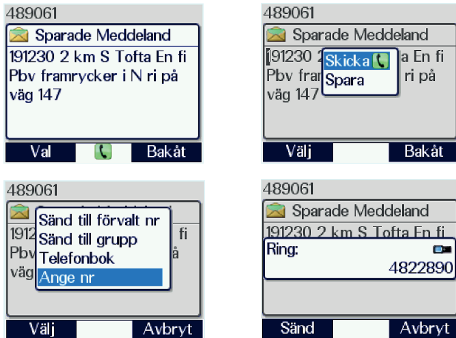
Bild 6.6. Sändning av meddelande till taktiskt nummer. Ett tryck på grön lur i första steget leder direkt till sändvalsrutan.
