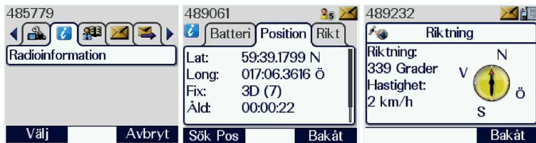
Bild 3.57. Radioinformation. Fliken riktning är från Ra 1445 och ser därmed lite annorlunda ut. Notera att kompassnålssymbolen är fixerad medan väderstrecksbokstäverna flyttar sig runt symbolen.
