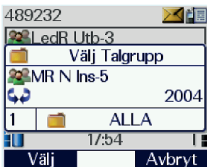
Bild 4.6. Teckenfönstret vid val av talgrupp med index. Notera att mappen ALLA visas i mappfönstret och att navigationspilarna inte längre visas. Möjligheten att använda väljarvredet till att korrigera valet finns dock kvar.
