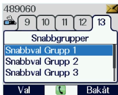
Bild 1. Användaren har definierat tre UDSL-listor med samma talgrupper. Varje lista har sin unika talgrupp vald. UDSL-listorna läggs som snabbgrupper på knapp 1, 2 och 3.
