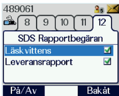
Bild 6.7. Fliken SDS Rapportbegäran. Hittas på Ra 1444 under "Inställningar" och på Ra 5444 i Meddelandemenyn.
