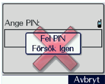
Bild 1. Om fel PIN-kod anges varnar radion med rött kryss och textruta.
