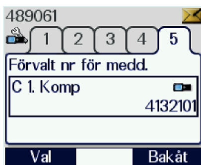
Bild 6.12 Menyfliken förvalt nummer för meddelande. För att ändra nummer se avnitt 3.5.1, Inställningar/Förvalt nummer för meddelande.
