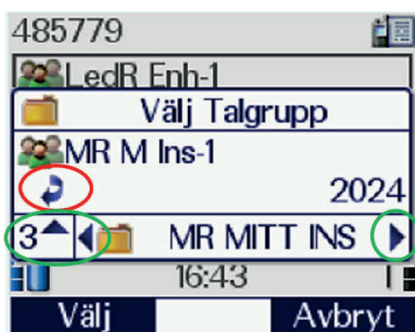
Bild 4.5. Teckenfönstret vid val av talgrupp med Mode- och pilknapparna. Pilarna i de gröna ringarna markerar möjliga navigeringsriktningar i mappträdet (se avsnitt 4.1.1). Siffran 3 anger att mappen MR MITT INS finns på mappnivå 3. Den röda ringen visar navigeringsriktningen för väljarvredet.
