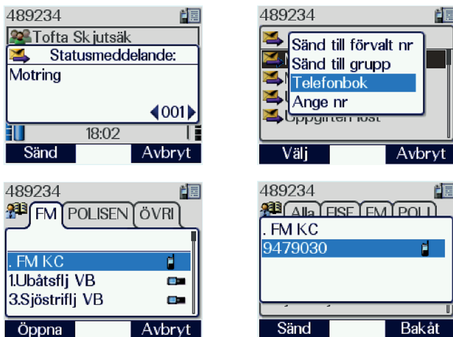
Bild 5.15. FMKC anropas genom sända Statusmeddelande "Motring".
