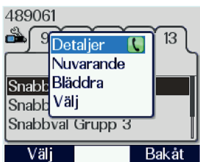
Bild 4.28. Valruta för inläggning av talgrupper finns direkt på menykortet där valen påverkar den markerade raden eller i detaljvyn där bättre kontroll över åtgärderna erbjuds. Lursymbolen anger att du kan snabbvälja denna funktion med grön lur. Valet "Detaljer" leder till detaljvyn. Valet "Nuvarande" används för lagring enligt avsnitt 4.5.2. och "Bläddra" används för lagring enligt avsnitt 4.5.1. och valet "Välj" väljer talgruppen direkt från menyn.
