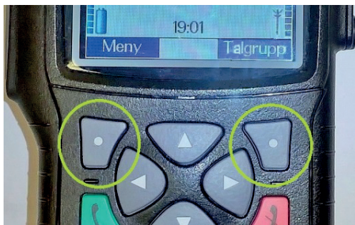
Bild 3.22. Vänster och höger funktionsknapp med aktuell menyfunktion i de mörkblå fälten. Gunnar Allard/Försvarsmakten
