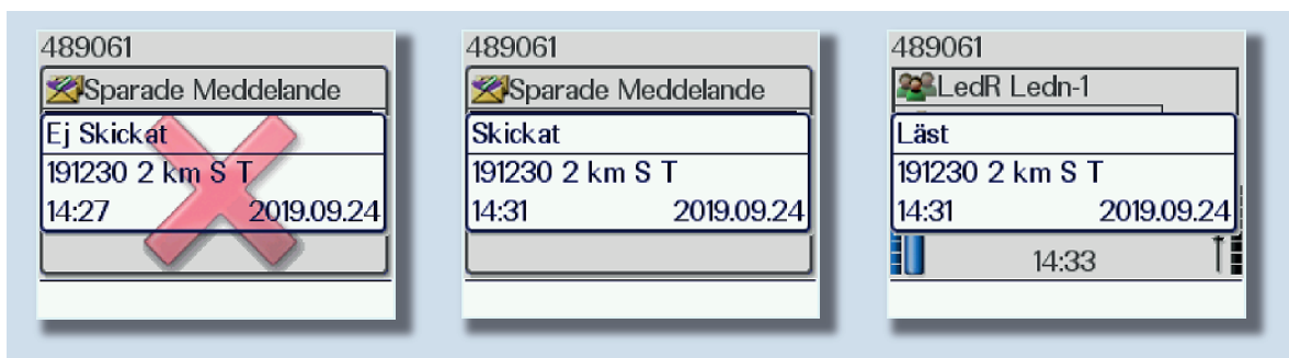
Bild 6.8. Leveransrapporter. Från vänster rapport om meddelandet inte nått mottagaren, till exempel på grund av att radiostationen varit avstängd. I mitten den rapport som visar att meddelandet nått mottagaren och till höger den rapport som visar att meddelandet varit öppnat. Gunnar Allard/Försvarsmakten
