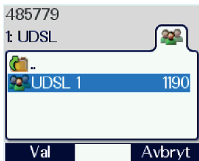
Bild 4.22. Val av UDSL via meny sker på samma sätt som val av talgrupp från meny. Endast ifyllda listor visas som valbara.
