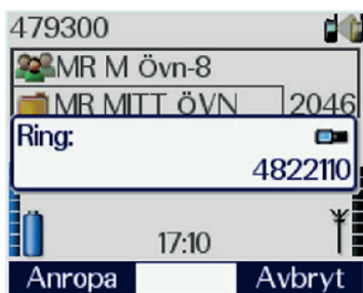
Bild 5.2. Inmatning av taktiskt nummer. Radiosymbolen ovanför numret anger att numret sänds till en nummeranalys som översätter numret till ISSI vilket sedan behandlas i växeln.
