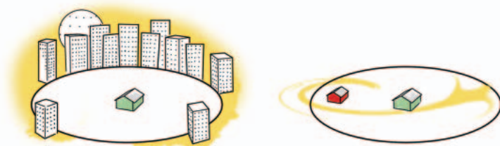
Bild 3:2 Ammunitionsförråd med skadeområde
