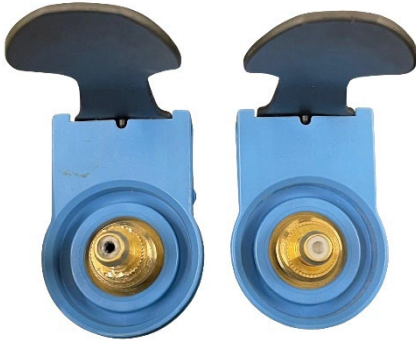
Bild 24 Avfyrad respektive ej avfyrad fördröjningsnippel övnhgrtändare 56D. Bild: Malin Erixon, Försvarsmakten.
