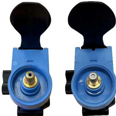
Bild 25 Avfyrad respektive ej avfyrad fördröjningsnippel övnhgrtändare 09D och 19D. Bild: Malin Erixon, Försvarsmakten.
