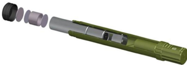
Bild 14 Handlysskottets delar i genomskärning. Illustration: Ur SÄKR EHV/PV 2023.
