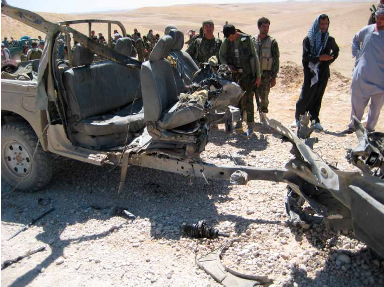
Kandakens standardfordon bestod av Ford Ranger pickup helt utan skydd. Att uppträda offensivt i en anfallsrörelse med den typen av fordon fick många gånger förödande konsekvenser för soldaterna. Fyra soldater dödades och fyra skadades mycket svårt när den här pick-upen körde på en IED (Improvised Explosive Device) baserad på en stridsvagnsmina. Mot den bakgrunden kom OMLT att lägga många dagar av arbete med att driva processen att tillföra HUMVEEs till 2. Kandak. (Foto: Patrik Bäck)
