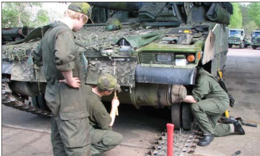
Stridsfordonet ska få en ny slutväxel och för att måste hela bandet tas bort. Foto: Åsa Andersson
