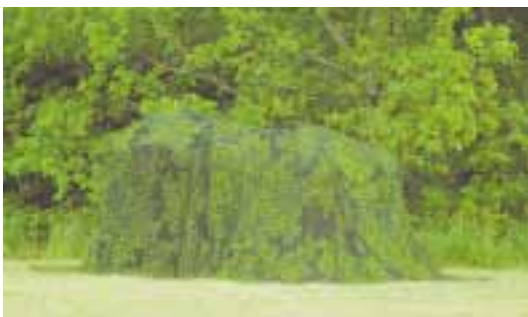
Terrängbil maskerad med IR-dämpande maskeringsnät
