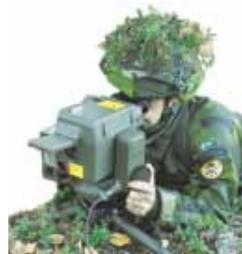
Avståndsmätning med e-trupplaseravståndsinstrument
