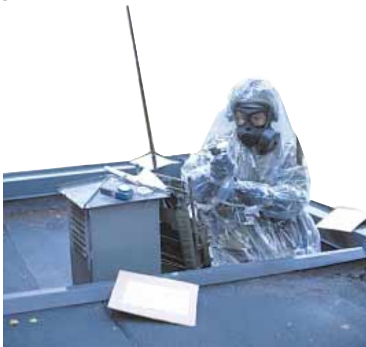
Luftindikering med sugpump och indikeringsbricka
