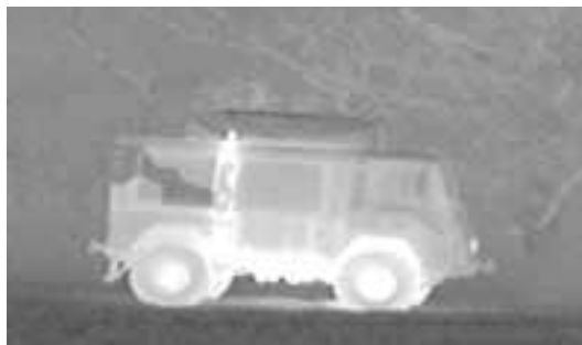
Terrängbilen som den upplevs i ett IRV-sikte (värmekamera/passiv IR). Det mörka fältet på terrängbilens övre vänstra del är målat med IR-dämpande färg
