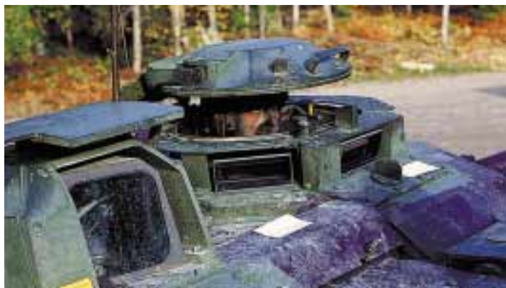
Indikeringspapper 105 placeras på minst två platser så att färgutslag syns. Papperet fästs lämpligen på en papp- eller träskiva
