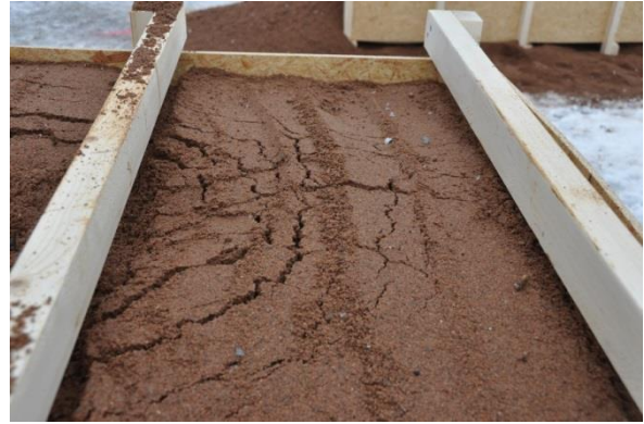
Figur 2-2 Sättningar i sandbädden efter strålens penetration (Skott 1:3).
