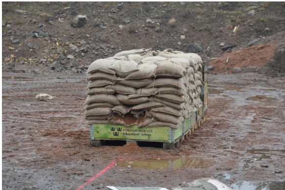
Figur 2-14 Sandsäcksbarriären efter träff (Skott 3:3).
