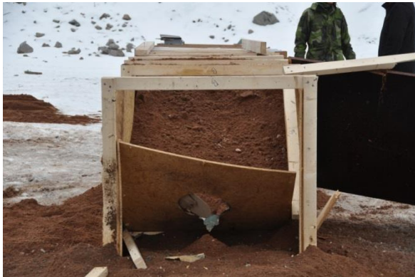
Figur 2-7 Sandbädd 1 efter skott (Skott 2:4).
