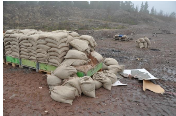
Figur 2-15 Sandsäcksbarriären efter träff (Skott 3:2).
