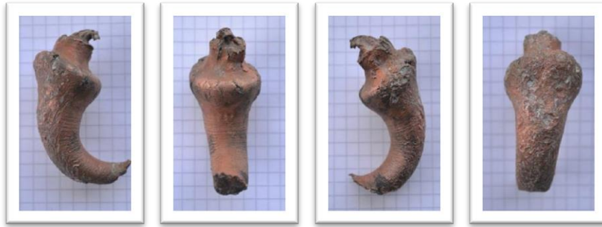
Figur 6-8 Sluggsegmenten uppvisar tydliga förslitningar efter kontakt med målmaterialet, förslitningar förekommer enbart på de ytor som exponerats i penetrationsriktningen (Skott 1:2).
