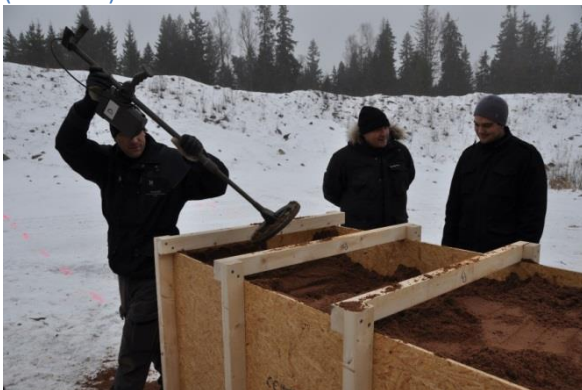
Figur 2-3 Strålsegment lokaliserade med metalldetektor innan friläggning skedde (Skott 1:4).
