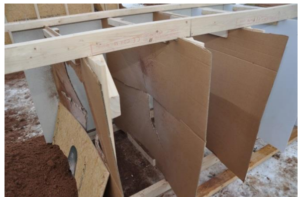
Figur 2-10 Vittresskivor efter skott (Skott 2:3).
