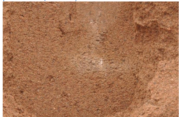
Figur 2-4 Penetrationskanalen syns tydligt i sandbädden som ljusare/torrare sand (Skott 1:4).
