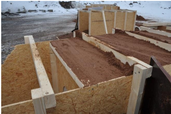
Figur 1-8 Målkonstruktion sandbädd del 1, motsvarande maximal penetration i sand minus 0,50 m.
