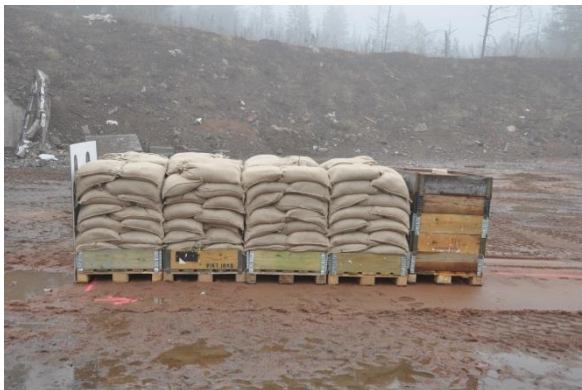
Figur 1-13 Sandsäcksbarriär med längden 3,20 m och tvärsnittet 1,20x1,00 m.
