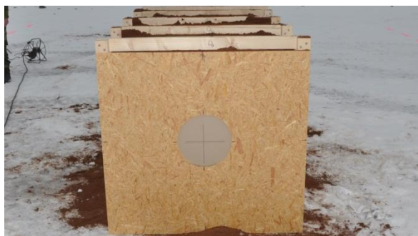
Figur 1-4 Konstruktion mål, kortsida med pappskiva för inträngning av RSV-stråle.
