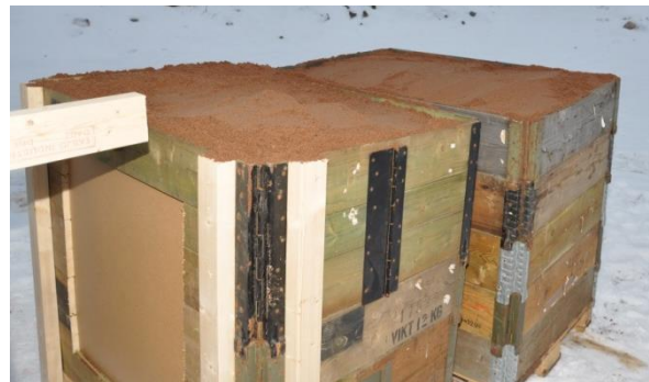
Figur 1-11 Målkonstruktion sandbädd del 2 för sluggens restverkan, bakom målet ett extra uppfång vid eventuellt genomslag.
