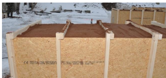
Figur 1-3 Målkonstruktion med sandfyllning packad genom trampning.
