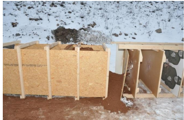
Figur 2-8 Sandbädd 1 efter skott (Skott 2:1).
