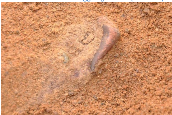
Figur 2-5 Frilagt sluggsegment i sandbädd (Skott 1:5).
