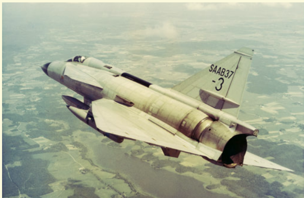
AJS 37 VIGGEN. Arbetet med Viggen började redan 1952, tre år före Drakens premiärflygning. Dock dröjde det till 1967 innan första prototypflygningen, alltså året innan den här bilden tas på det tredje prototypflygplanet. Byggdes i fyra olika versioner för uppgifterna attack-, jakt-, spanings- och skolflygplan. Kunde landa på mycket kort landningsbana: 500 meter var vad som krävdes. Gjorde sin sista flygning den 25 november 2005 på F21. 329 exemplar byggdes, men lyckades aldrig exporteras.
