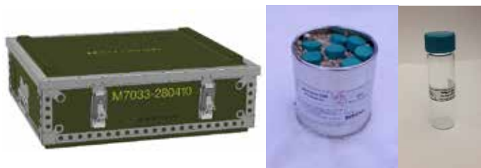
Bild 8.1. Transportlåda för senapsgas rymmer 5 st plätburkar, innehållande vardera 8 st senapsgasrör med SENAPSGAS 2000 M4746-805101 (12-12,5 ml) eller SENAPSGAS 2000M 4746-805102 (4ml).
