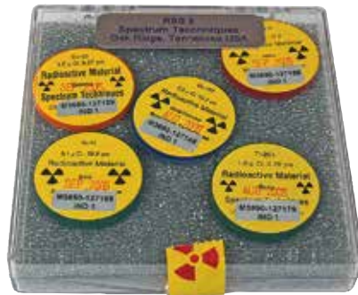
Bild 11.6. Förvaringsask för strålkällor
