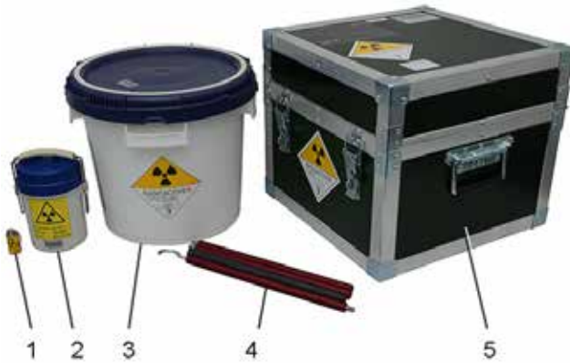
Bild 10.3. Radiakpreparat 6 (1), inre skyddsbehållare (2), yttre preparatbehållare (3), hanteringsstav (4), ytteremballage (5).
