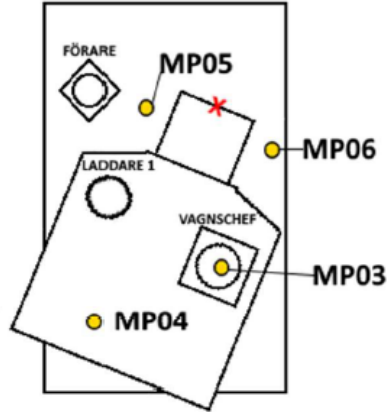
Bild 7.11. Exempel på laddarnas placering vid skjutning med reservförfarande.
