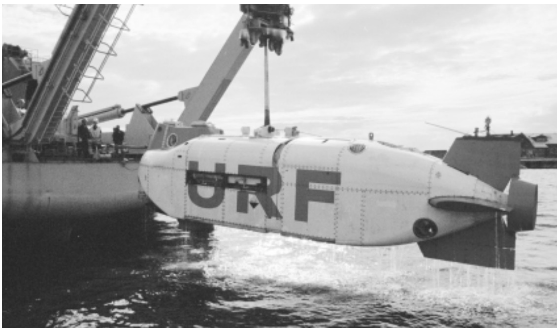
URF lyfts upp på Belos under ubåtsräddningsövningen där miniubåten skulle dockas med ubåten Halland på botten utanför Karlskrona. foto: Andreas Karlsson, Försvarets bildbyrå
