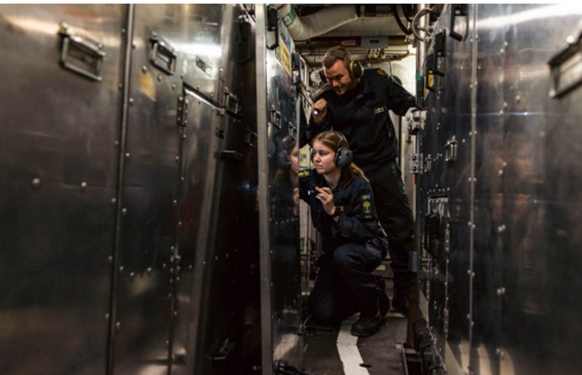
Motormännen Hanna Liljekvist och Henrik Edlund gör regelbundna kontroller av fartygets maskiner, som är inneslutna i ljuddämpande skåp.
