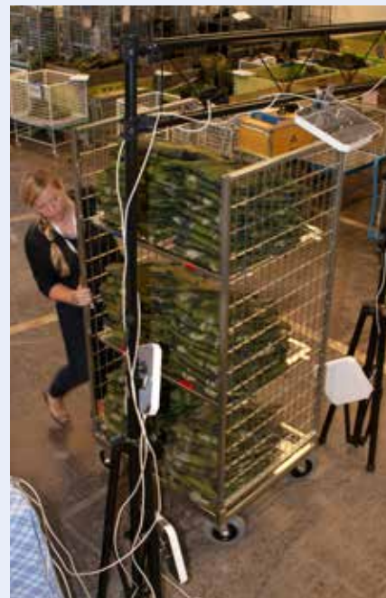
Förrådsman Emma Hedlund kör en depåvagn genom en fast läsare, som på några sekunder registrerar alla RFID-märkta plagg i vagnen.
